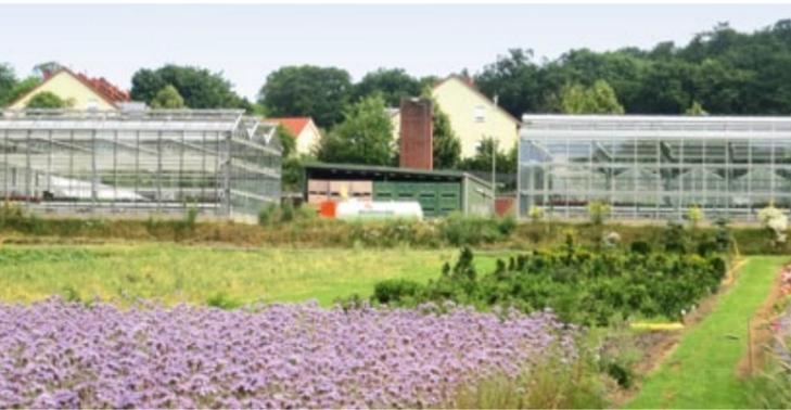
Großversuch in nahezu identischen Vergleichsgewächshäusern: Ein Haus ist mit Wärmeschutzverglasung, das andere mit konventionellem Einfachglas ausgestattet.
