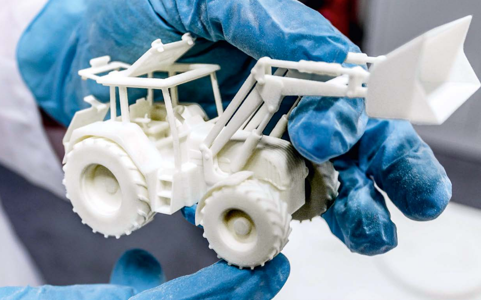
Ein Miniatur-Traktor, komplett aus dem 3D-Drucker: Würde man ihn auf dem Tisch anstoßen, rollt er los. Entstanden ist der Traktor im Labor für Produktentwicklung und CAE (Computer-aided engineering) auf dem Campus Westerberg.
