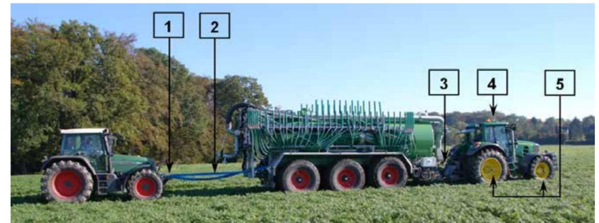
Abb. 2: Zugkraft-Schlupf-Messung auf dem Feld: 1) Zugkraft-Messdose, 2) Zugseil, 3) Topzylinder, 4) GPS-Gerät, 5) Raddrehzahlsensoren
