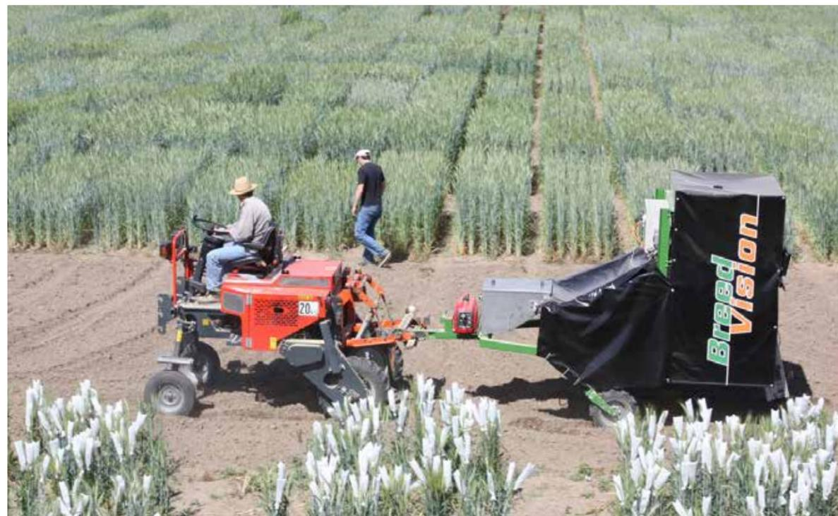
Abb. 1: Sensorplattform BreedVision bei Feldmessungen
