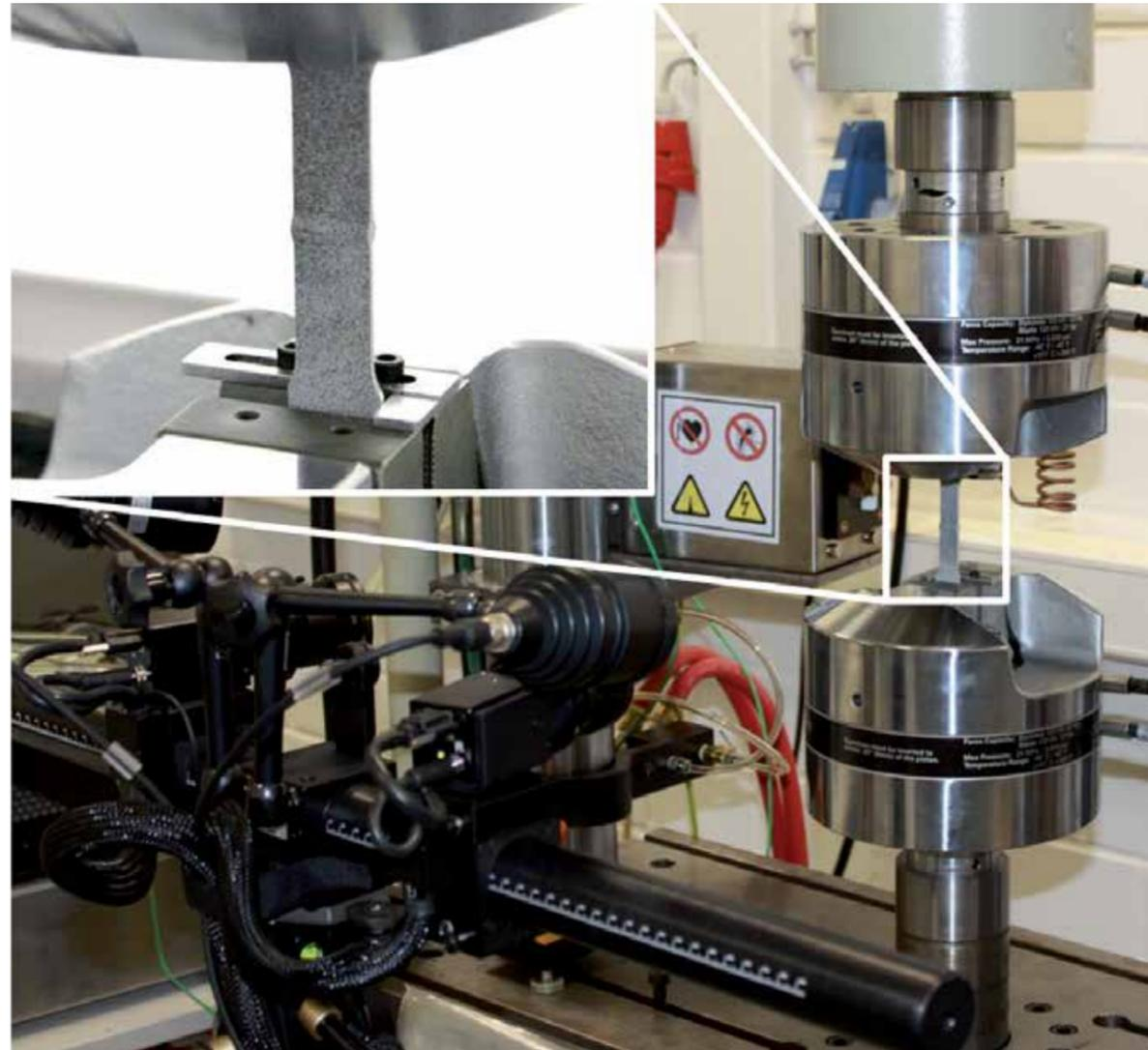
Abb. 2: Versuchsaufbau für Zug- und Ermüdungsversuche
