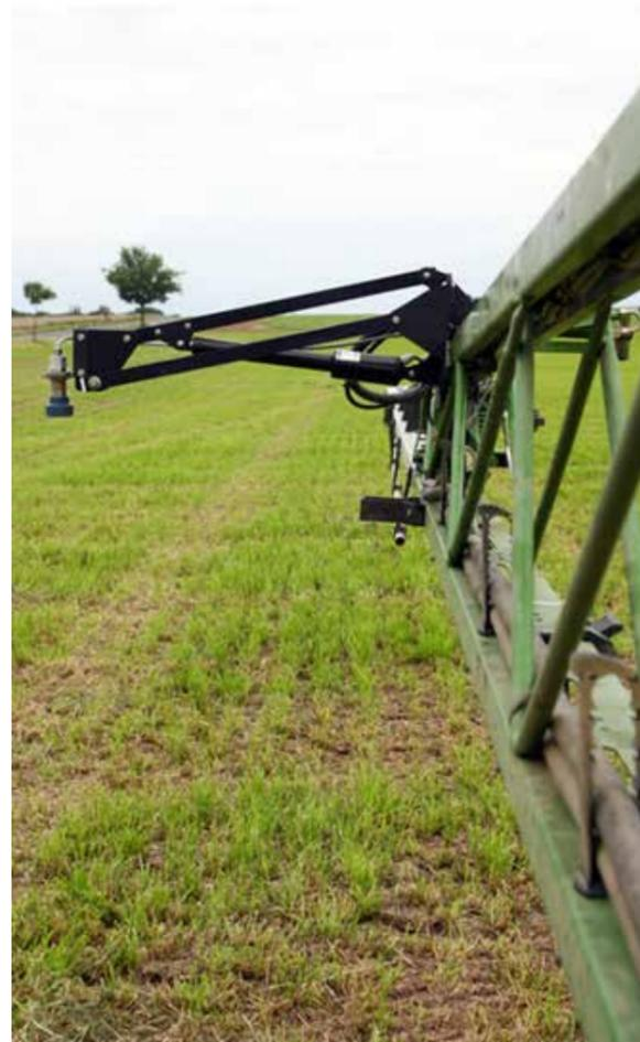
Abb. 1: Feldversuch mit dem an einem Spritzbalken angebrachten Ultraschallsensor (Quelle: AgriCon)
