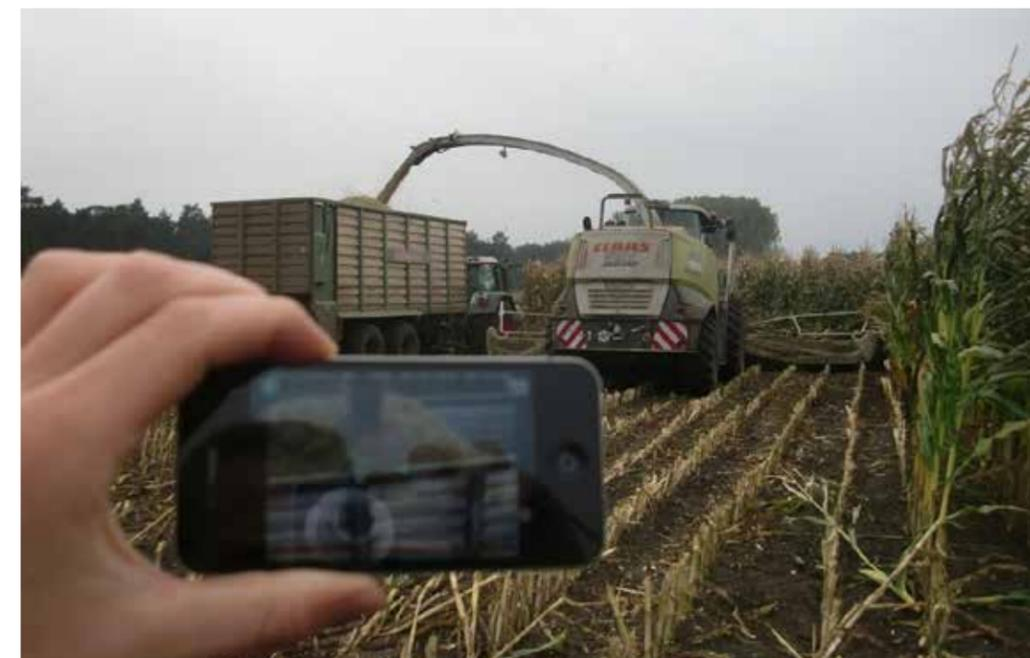
Abb. 4: Videobild über WLAN gibt Aufschluss über den Befüllungsgrad des Anhängers
