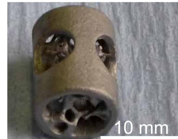
Abb. 1: Titan-Aluminium-Niob (Ti-6Al-7Nb) Implantatkörper
