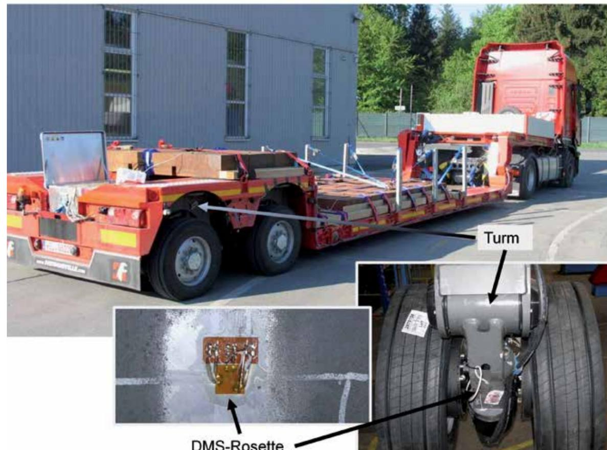
Abb. 1: DMS-Rosette auf dem Turm der Pendelachse
