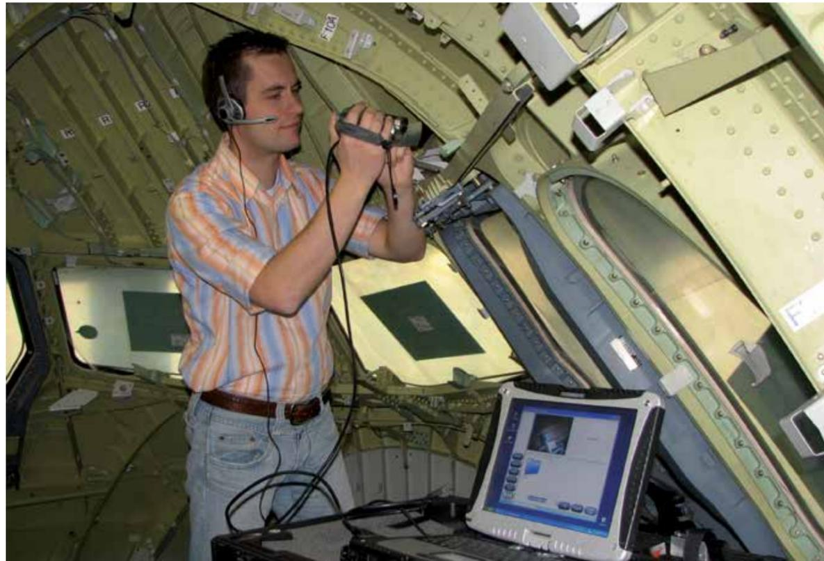
Abb.: Online Maintenance Assistance (OMA 2.0) im Cockpit eines A380
