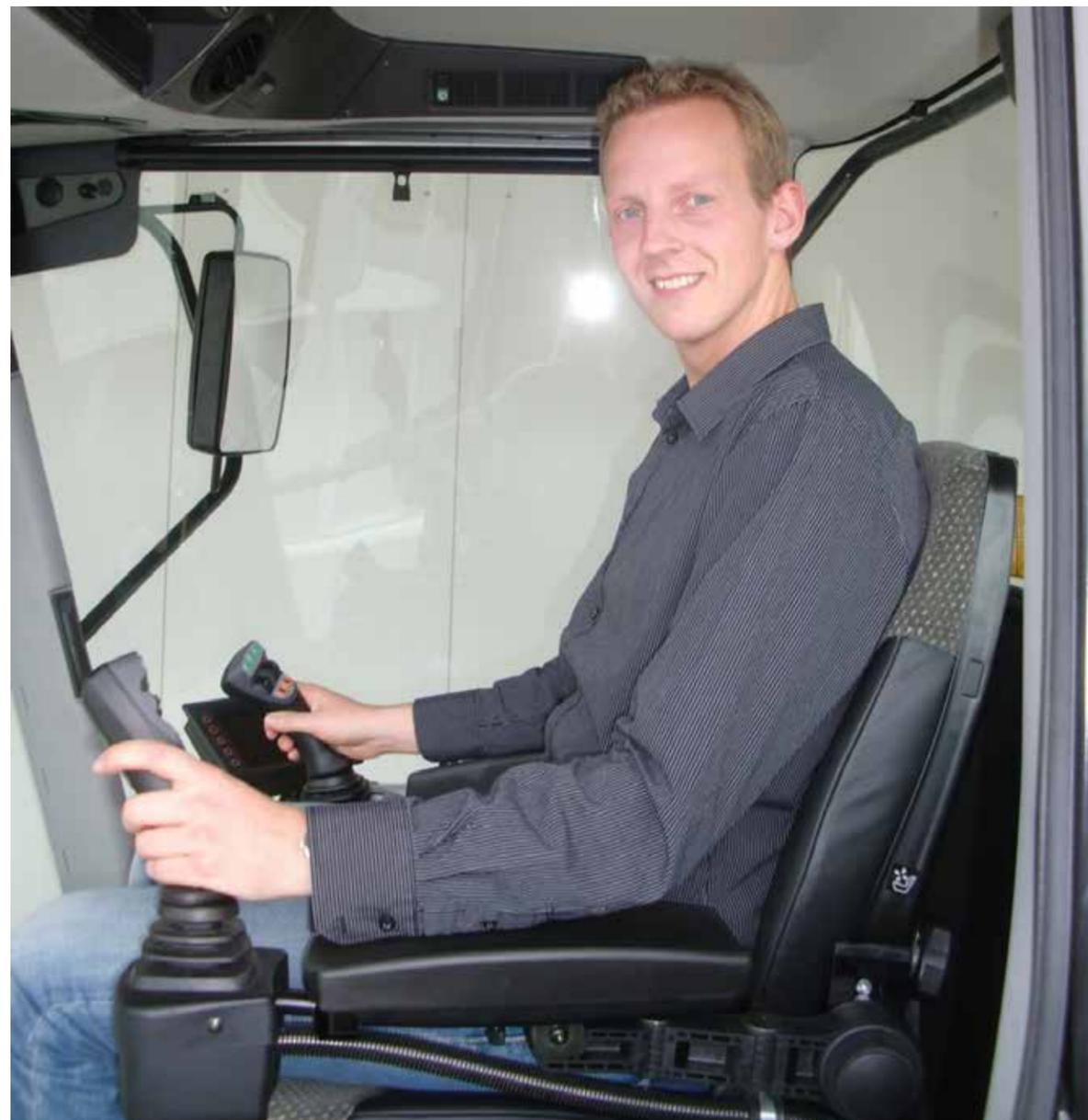
Abb. 3: Panoramakabine mit 2 Joysticks zum Bedienen der Maschine
