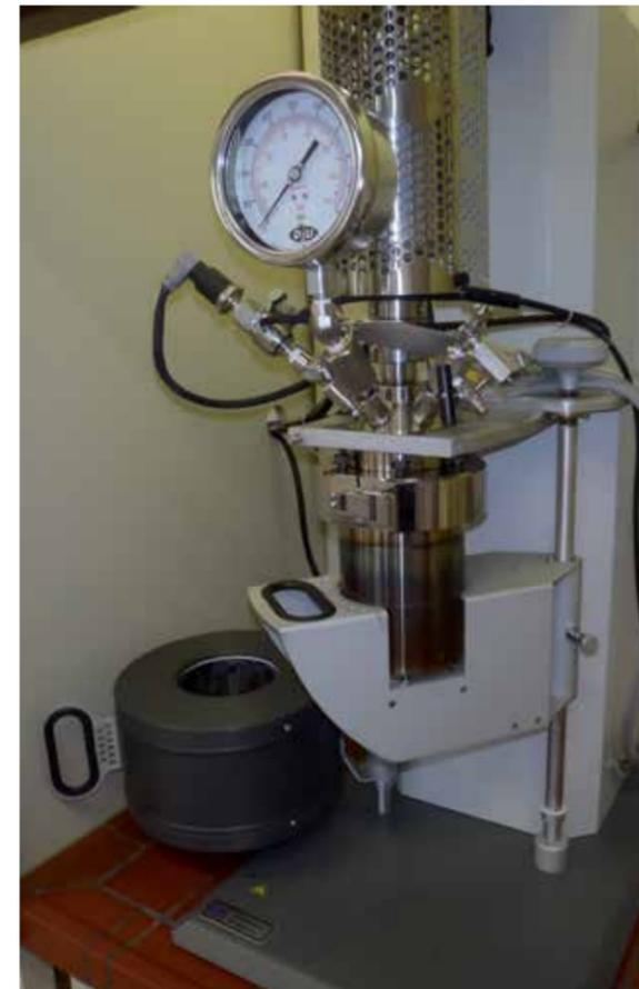
Abb. 2: Labordruckreaktor
