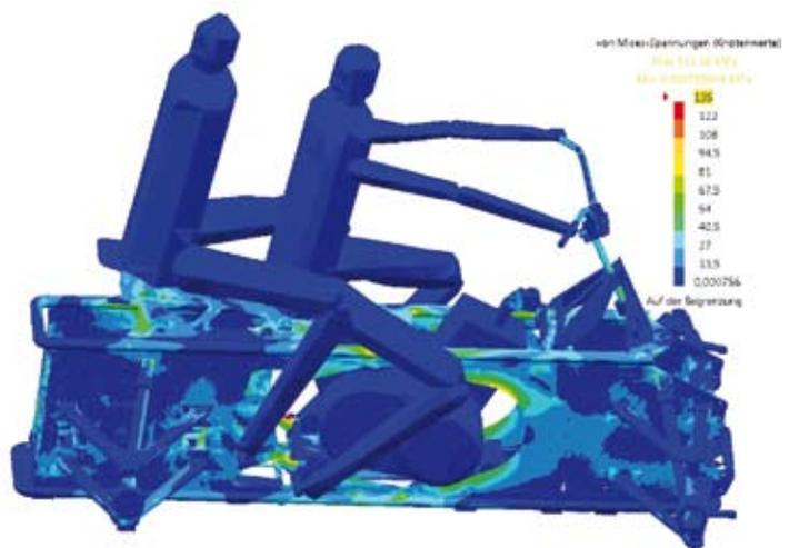
Abb.: Verlauf der von Mises Spannungen im Quad nach seiner Optimierung
