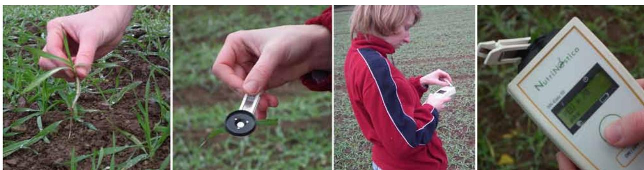
Abb. 1: Einsatz des Mangan-Schnelltesters NN-Easy 55 (von links: Entnahme von Pflanzen zur Messung - Befestigen des Messclips am Blatt - Aufsetzen des Messclips an die Messoptik des Mn-Schnelltesters - Durchführung der Messung und Ablesen des Mn-Versorgungszustands)
