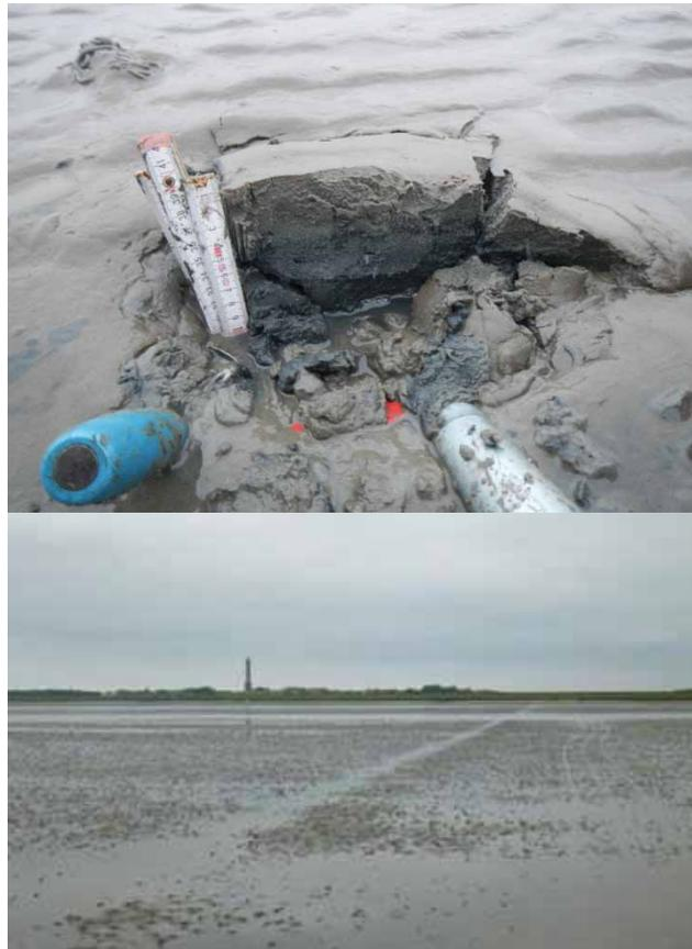
Abb. 1: Wattboden mit oxidiertem und reduziertem Horizont (oben) und linienhafter Verlauf des Kabelschlitzes nach baulicher Maßnahme (Fotos: Makowsky / Schumann)
