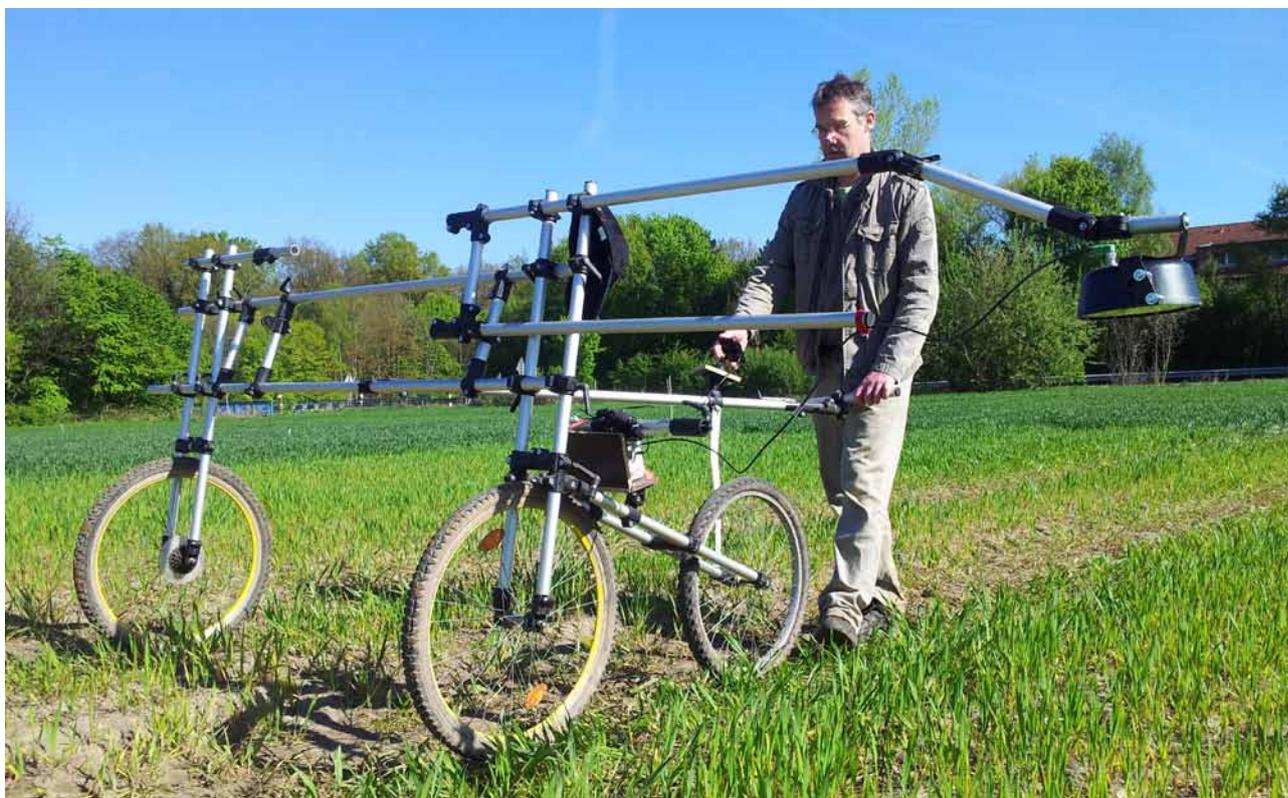
Abb. 1: Sensormessungen mit Messgestell in einem Weizenbestand (Bild: S. Reusch [Yara], 2014)
