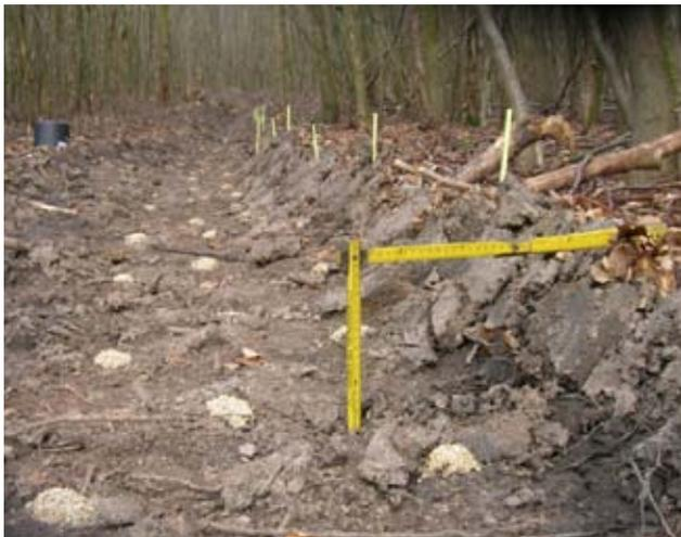
Abb. 2: Versuchsgasse im Wald mit Regenerationsmaßnahme (Brannkalk verfüllt in Stanzlöcher)
