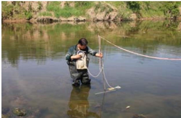
Abb. 2: Messung der Wasserfließgeschwindigkeit im FengLe-River
