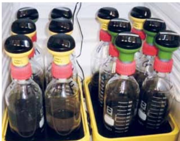
Abb. 2: Gasdruckmessung im Klimaschrank
