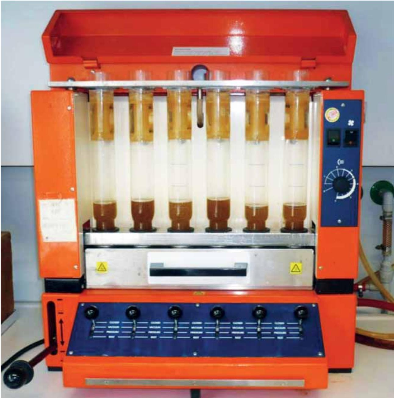
Abb. 1: Aufschluss der NDF - Heißextraktionsapparat
