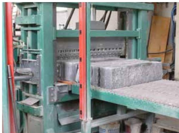
Abb. 10: Herstellung von Platten aus Steinblöcken mittels Cracker
