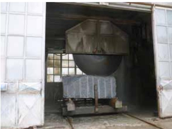
Abb. 9: Bearbeitung eines Steinblocks mittels Säge
