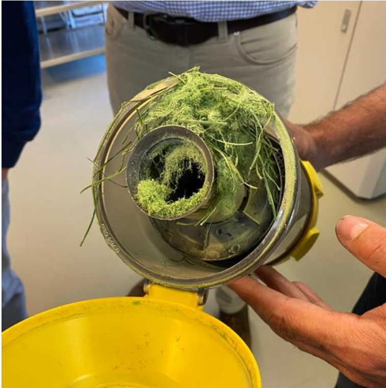
Abbildung 41: Kunststoffabrieb in der Absauganlage des modifizierter Lisson Tretrad-Test nach DIN EN ISO 12951:2020-10
