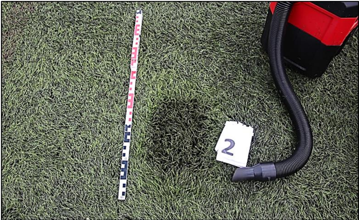
Abbildung 50: Absaugen des Füllstoffes mittel Milwaukee M18 VC-2
