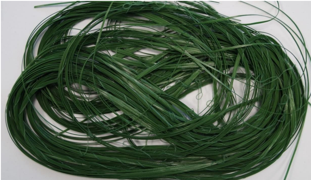
Abbildung 37: Endlos extudierte LLDPE-Fasern für Kunststoffrasen
