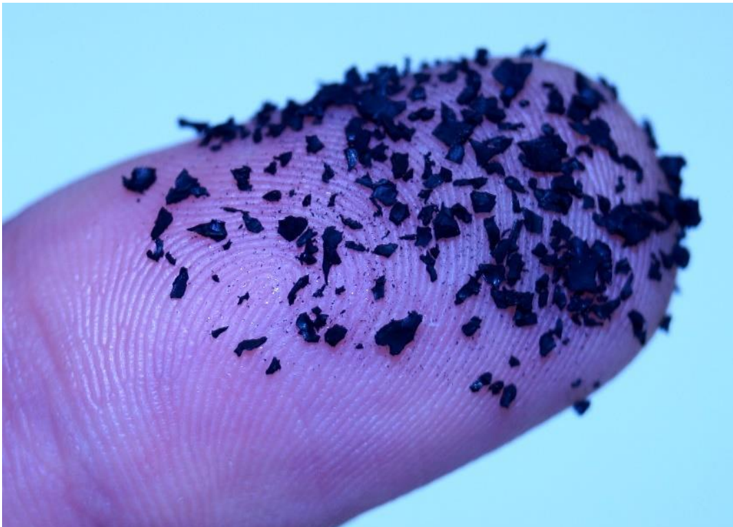
Abbildung 2: Sekundäres Mikroplastik, hier Abrieb synthetischer Füllstoff aus einem Kunststoffrasen
