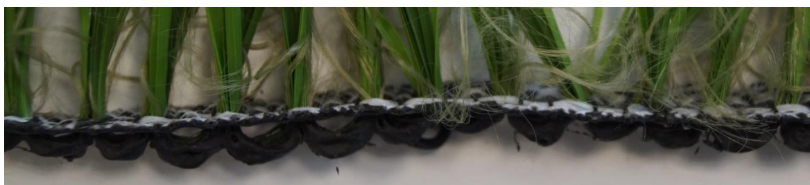
Abbildung 57: Unterschiedliche Schlaufengrößen der Faserbündel unterhalb des Trägergewebes
