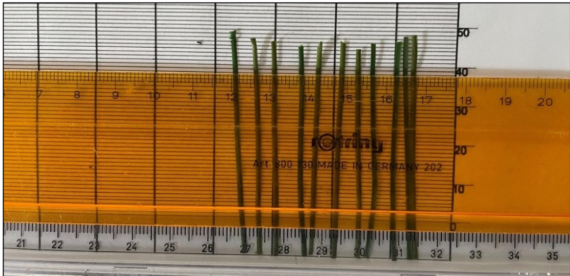
Abbildung 54: Differenzierung zwischen Faserbruch und Faserverschleiß durch Ausmessen
