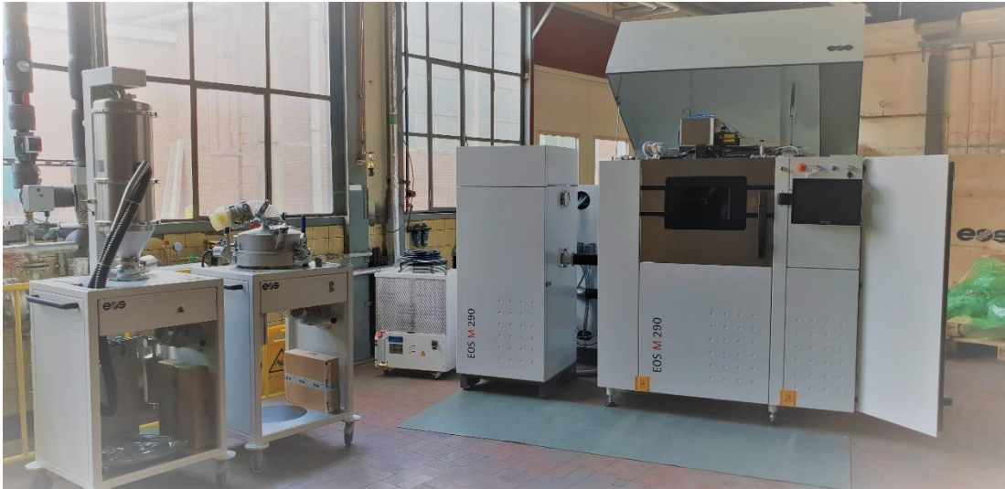
Foto (Quelle: ©KME): 3D-Drucker EOS M290 mit rotem und grünem Laser zum selektiven Laserschmelzen im Pulverbett
