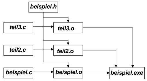
Zur Erzeugung der gewünschten Datei muss der Abhängigkeitsgraph durchsucht werden. Wenn Quelldateien aktueller sind als davon direkt oder indirekt abhängige Dateien, müssen diese neu erzeugt werden.
