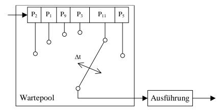
Das Time Sharing System bringt die Prozesse nach einem bestimmten Zyklus für einen Zeitabschnitt Δt (Zeitscheibe) zur Ausführung, dann schaltet es zu einem anderen Prozess um. Damit wird ein Prozess schrittweise ausgeführt bis er abgearbeitet ist.
