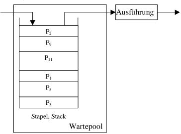
Bei Verwendung eines Wartepools mit LIFO-Strategie (Stapel, Stack) wird der Prozess, der zuletzt in der Wartepool eingestellt wurde, als erster zur Ausführung gebracht.
