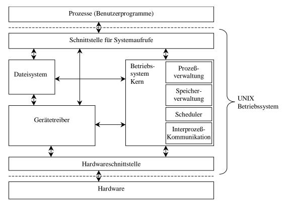
Das UNIX Betriebssystem erlaubt das Ausführen mehrerer Prozesse nach Prioritätensteuerung und Time Sharing. Die Prozesse kommunizieren mit dem Betriebssystem über Systemaufrufe, für welche eine eindeutige Schnittstelle existiert.
