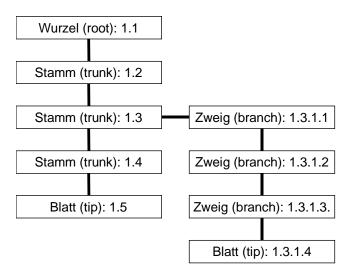
Wird die Quelldatei in Schritten verändert und zwischenzeitlich wieder in die Versionsverwaltung "eingecheckt", wird bei jedem Ein-Checken eine neue Revisionsnummer vergeben. Man erkennt dies am Stamm des Revisionsbaumes, wo die Revisionen 1.2 bis 1.5 angelegt sind.
