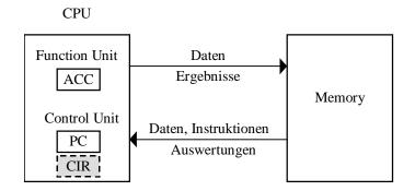
Die Steuereinheit entschlüsselt (dekodiert) Befehle und steuert deren Ausführung. Der aktuell bearbeitete Befehl befindet sich im Befehlsregister. Zu jedem Zeitpunkt führt die CPU genau einen Befehl aus.
