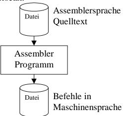
Der Mnemocode wird 1:1 in Maschinencode übersetzt.
