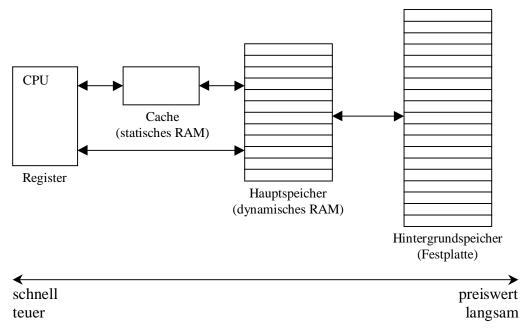
In Rechnern besteht eine Speicherhierarchie mit den Registern in der CPU an der Spitze und dem Hintergrundspeicher an der Basis. Der Speicher an der Spitze der Hierarchie ist sehr schnell im Zugriff aber auch sehr teuer. Der Hintergrundspeicher an der Basis ist preiswert, aber der Zugriff auf diesen Speicher ist langsam.
