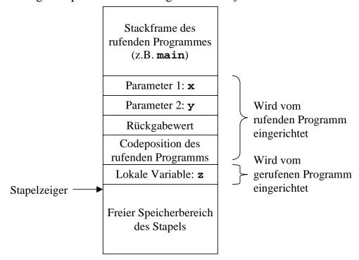
Der Zugriff auf die Variable **z** (Größe 4 Bytes) erfolgt beispielsweise mit der Adresse (Wert des Stapelzeigers)+4. Benötigt man ebenfalls 4 Bytes zur Speicherung der Codeposition (Größe ist prozessorabhängig), so erfolgt beispielsweise der Zugriff auf den Parameter **x** mit der Adresse (Wert des Stapelzeigers)+20. Beim Beenden schreibt die Funktion **poly** ihren durch die **return**-Anweisung spezifizierten Ergebniswert in die Speicherzelle mit der Adresse (Wert des Stapelspeichers)+12.
