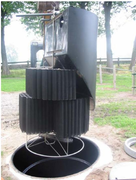
**Bild 2: Hauptreinigungsstufe und Nachklärbecken**
