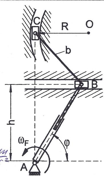
1. die Geschwindigkeit und die Beschleunigung des Kolbens **B**;
