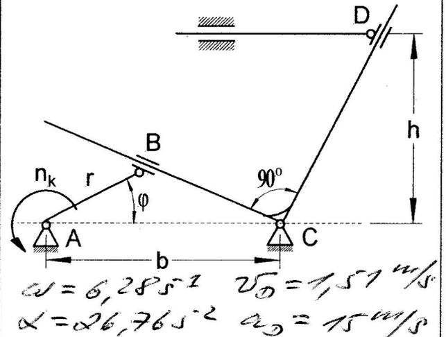
**Aufgabe 2:** Die skizzierte Kurbelschwinge wird über die Kurbel AB (Länge r) mit der **konstanten** Winkelgeschwindigkeit  $\omega_A$  angetrieben und dreht sich in der horizontalen Ebene. Der gelenkig mit der Kurbel verbundene Gleitstein B gleitet reibungsfrei in der Führungsnut der Schwinde CD. Für die skizzierte Lage bestimme man:
