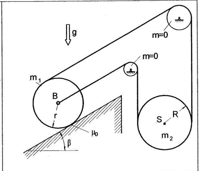
**Aufgabe 4:** Das skizzierte schwingungsfähige System besteht aus einer Kreisscheibe (Masse  $m_1$ , Radius  $r$ ), einer Platte (Masse  $m_2$ ), einem Dämpfer (Dämpfungskonstante  $k$ ) und zwei Federn (Federsteifigkeiten  $c_1$  und  $c_2$ ). Die Kreisscheibe rollt auf der Platte ohne zu gleiten (Haftreibungskoeffizient  $\mu_0$  ist ausreichend groß). Die Bewegung zwischen Platte und Unterlage ist reibungsfrei ( $\mu = 0$ ).
