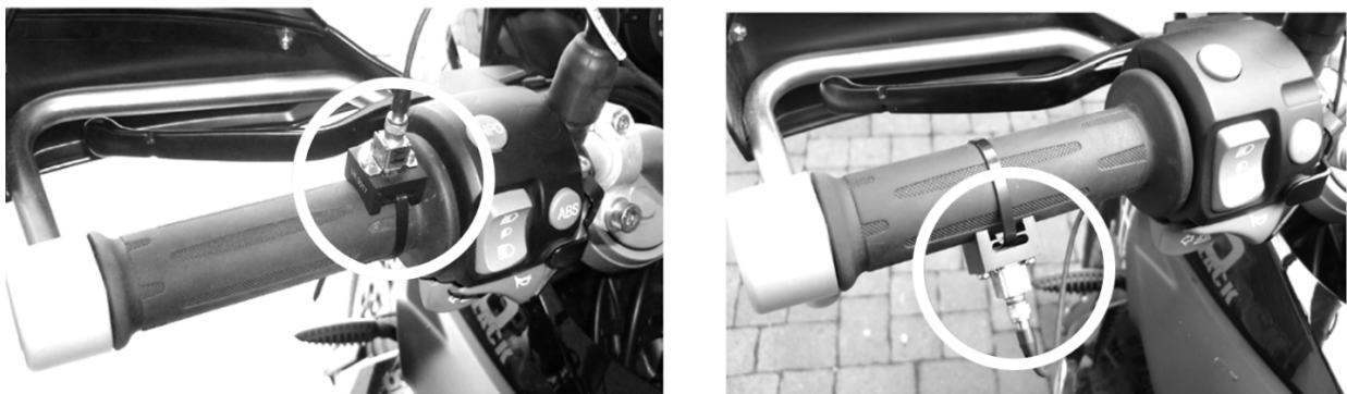
Abb. 5 Sensor am Handgriff an Griffinnenseite (Bild links) und Griffmitte (Bild rechts)
