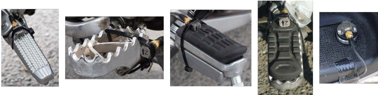
Abb. 4 Beispiele zur Applikation der Beschleunigungsaufnehmer an verschiedenen Fußrasten/-plattformen.
