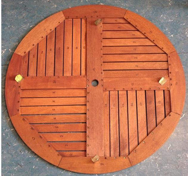
Insgesamt wurden **20** verschiedene botanische Gattungen / Arten für die **52** Bauteile eines Klapptisches lichtmikroskopisch bestimmt!
