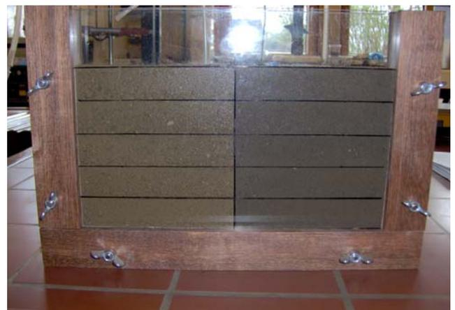
**Abb. 1:** Versuchsküvette. Die horizontalen Linien sind Hilfslinien für die kontrollierte Verdichtung des Substrats
