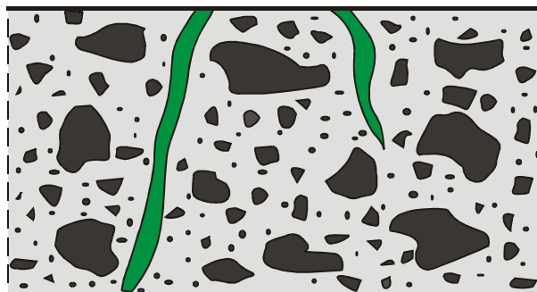
Bild 5.1: Füllen von Rissen und Hohlräumen mit Reaktionsharzen, Zementleimen oder Zementsuspensionen
