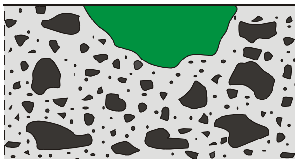
Bild 5.2: Ausfüllen von örtlichen Fehlstellen mit Mörtel oder Beton
