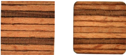
Abbildung 3-4 Vergleich der Anzahl der Furniere mir parallel und senkrecht laufenden Fasern zum Schnitt von den Proben der Messreihe A, B und C (links) und den restlichen Proben (rechts) mit der derselben Qualitätsstufe „LI /2 E3“
