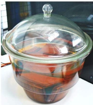
Abbildung 3-25 Zwischenlagerung der ölprägnierten KP-Holzplatten in einem Exsikkator
