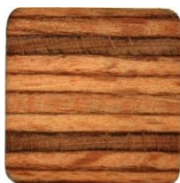
Abbildung 3-2 Querschnitt des Stabes mit 2 mm Radius
