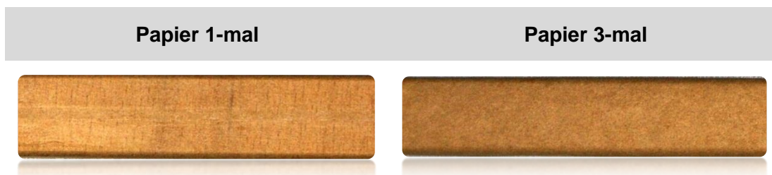
Abbildung 3-7 Oberflächenbeschichtung von Stäben mit Ölpapier (Ansicht senkrecht zur Schichtung)
