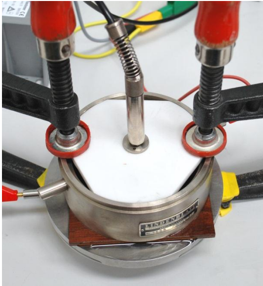
Abbildung 3-23 \epsilon_r - und \tan \delta - Messung von KP-Holzplatten mit Anpresskraft an der ringförmigen Elektrode
