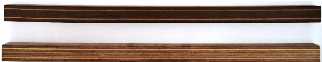
Abbildung 3-1 KP-Holzstäbe der Größe 18 x 18 x 400 mm, abgerundete Kante (R = 2mm) (oben - KP 20214, unten – KP 20212)
