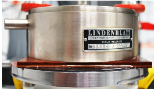
Abbildung 3-24 \epsilon_r - und \tan \delta - Messung von KP-Holzplatten mit anliegender KP-Holzplatte
