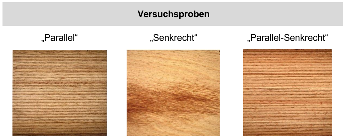
Abbildung 2-9 Versuchspuben mit unterschiedlichen Schnitt zur Faserrichtung
