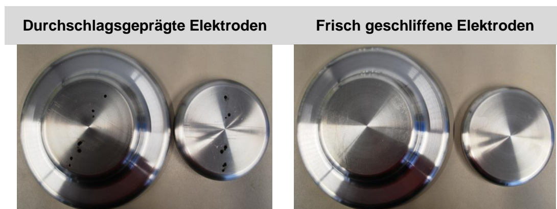
Abbildung 3-18 HSP-Tellerelektrode und Erdpotenzialelektrode nach (links) und vor (rechts) der Prüfung
