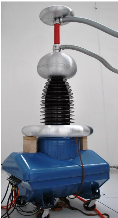
Abbildung 3-13 300 kV Prüftransformator der Firma Siemens
