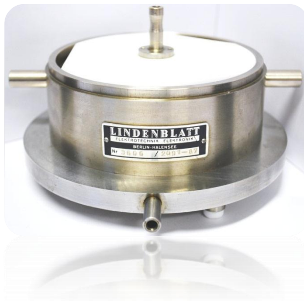
Abbildung 3-22 Schutzringelektrode, geschützte Elektrode Durchmesser von 100 mm
