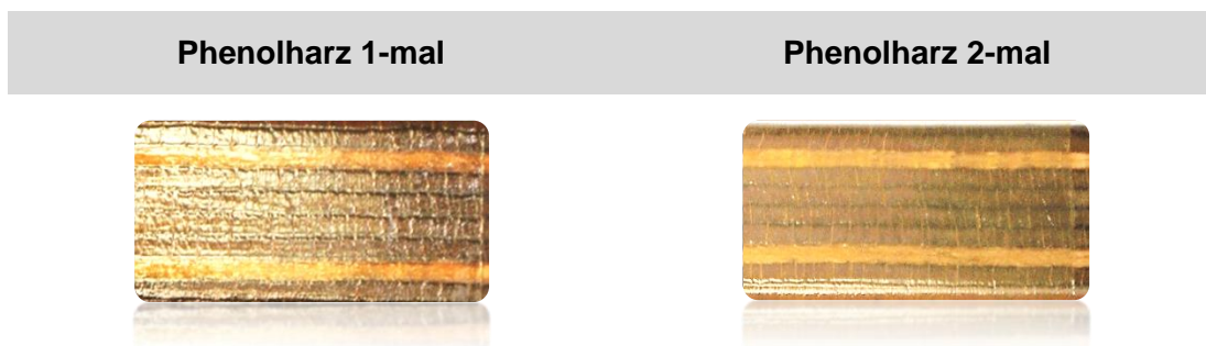
Abbildung 3-6 Oberflächenbeschichtung von Stäben mit Phenolharz
