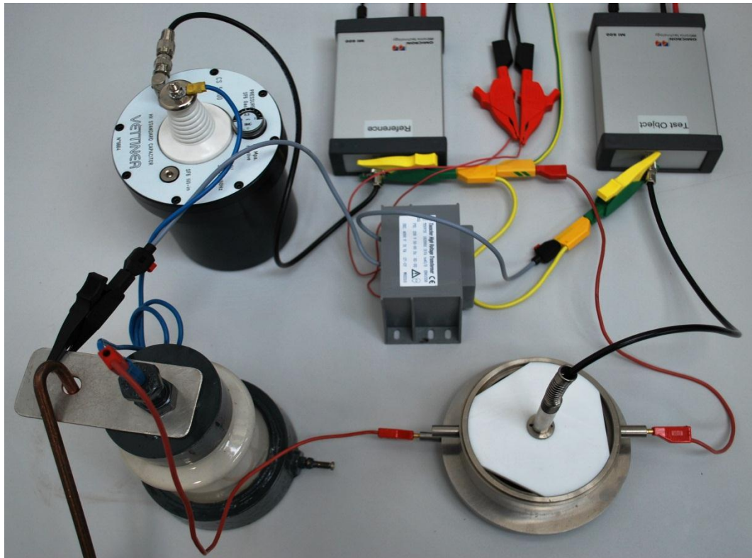
Abbildung 3-19 Übersicht der Messeinrichtung für die dielektrische Untersuchung
