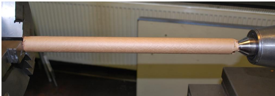
Bild 4-65 Prüfelektrode \varnothing 30 \text{ mm} mit einer Papierschichtdicke von 2 mm nach dem Bandagieren an der Drehbank der Betriebswerkstatt der Hochschule Osnabrück
