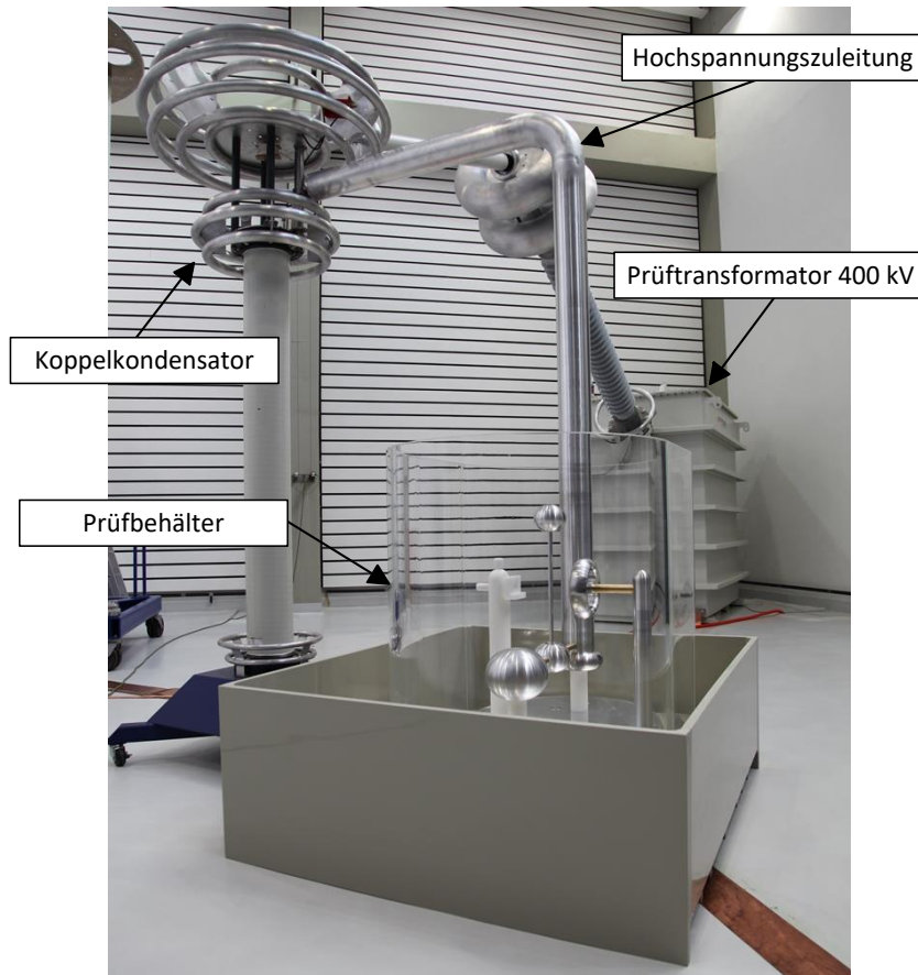
Bild 4-57 Gesamtübersicht des vollständigen Prüfaufbaus und Kennzeichnung der Betriebsmittel im Labor für Hochspannungstechnik der Hochschule Osnabrück
