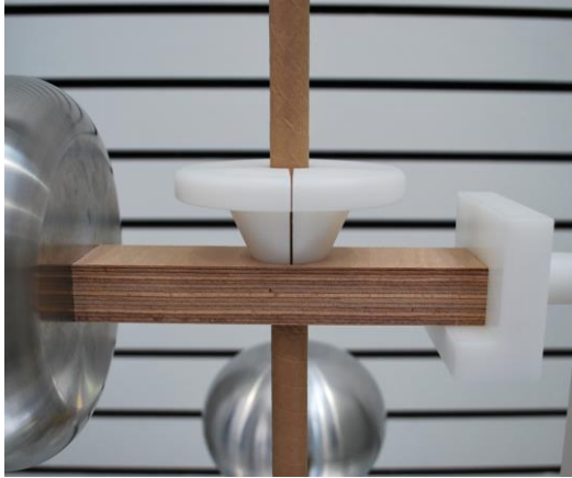
Bild 4-60 Voreinstellung der Prüfanordnung mithilfe eines kegelförmigen Abstandshalters
