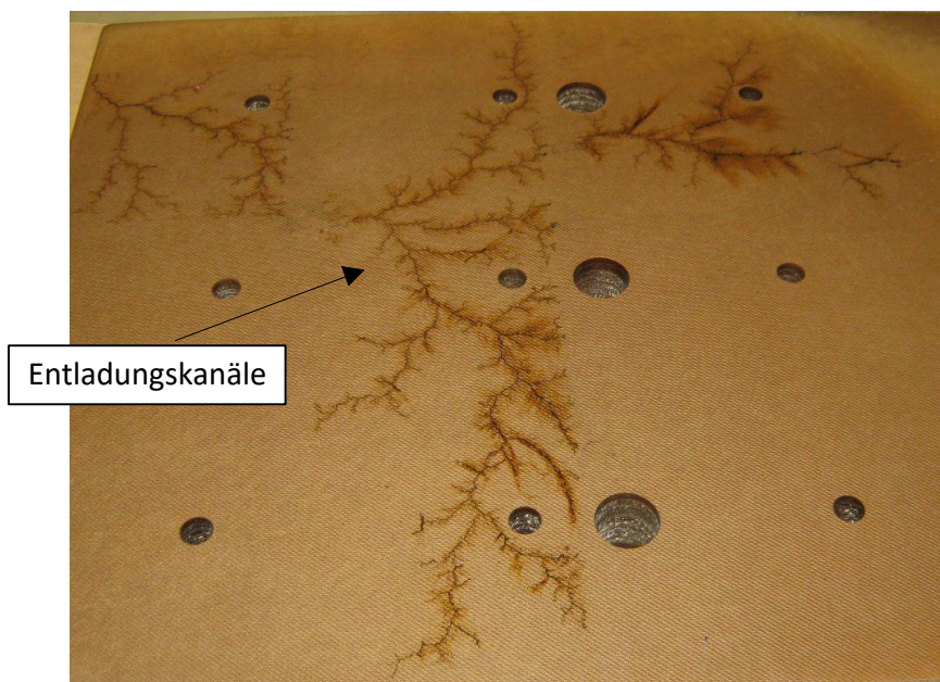
Bild 1-2 Typische Entladungsstrukturen an einem Drucksegment aus Blockspan (Foto Siemens AG ETTR)
