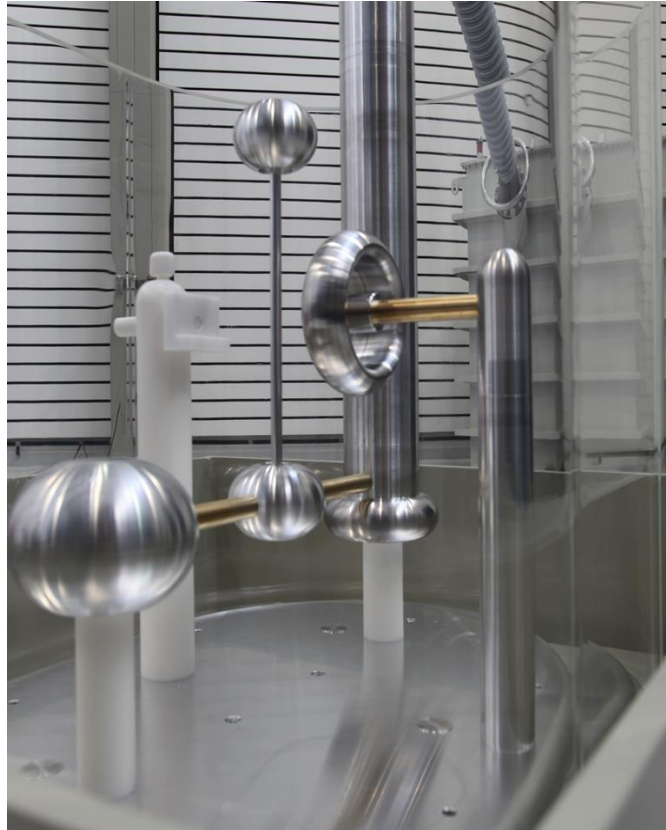
Bild 4-59 Elektrodenanordnung im Prüfbehälter im ursprünglichen Zustand ( \varnothing Prüfelektrode = 16 mm, Isolierstrecke 80 mm)
