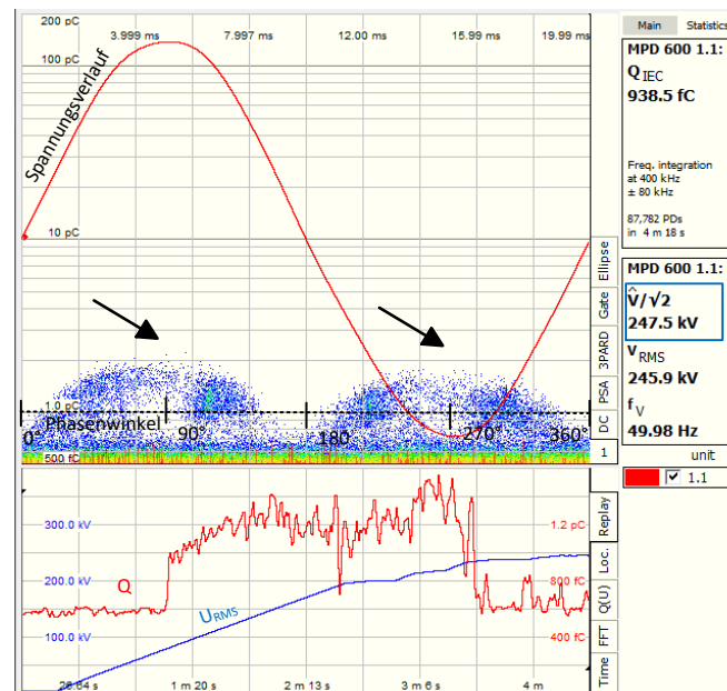
Bild 4-21 TE-Aufnahme mit charakteristischem Muster für Hohlraumentladungen
