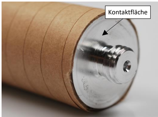
Bild 4-66 Bearbeitete Enden einer Prüfelektrode nach der Bewicklung an der Drehbank
