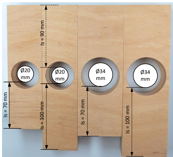
Bild 4-53 Auswahl der KP-Holzproben für Vorversuche für die Isolierstrecken 70 mm, 90 mm und 100 mm
