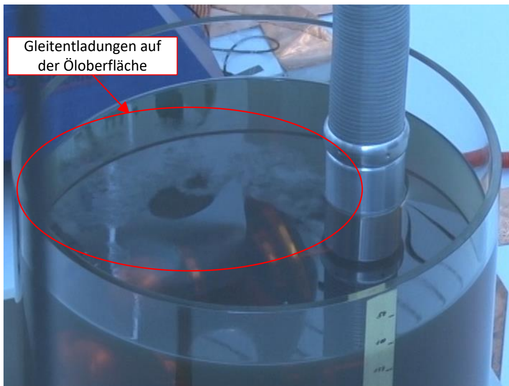
Bild 4-3 Gleitentladungsbeobachtungen auf der Öloberfläche
