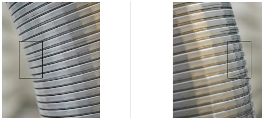
Bild 4-26 Flexschlauch – Oberflächenstruktur bei gekrümmtem und gestrecktem Hochspannungsrüssel
