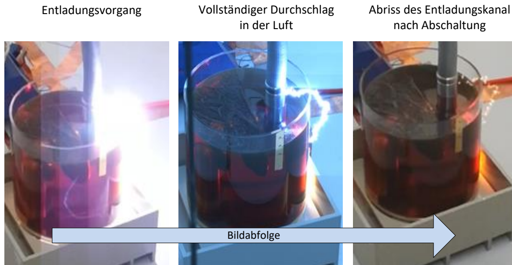
Bild 4-12 Bildabfolge Entladungsvorgang in Luft vom Schlauchanschluss
