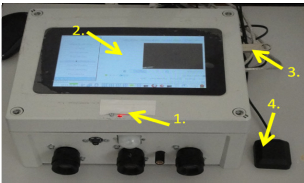
Bild 5: GPS-Modul (1), Touch-Display (2), USB-Stick (3), externe GPS-Antenne (4)
