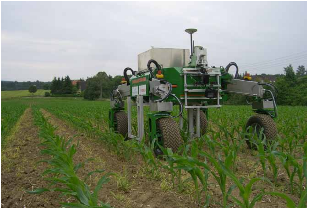
Abb. 1: Autonomer Feldroboter BoniRob bei der Vermessung von Einzelpflanzen auf einem Maisfeld
