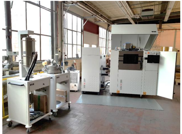
EOS M290 Customized mit Siebstation und Fördermodul
