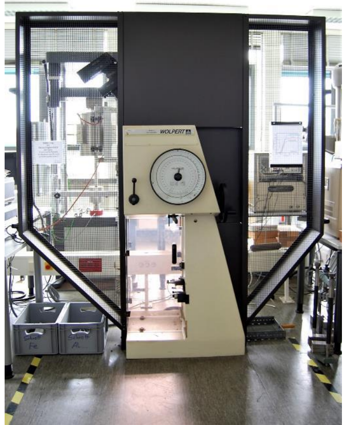
Kerbschlagbiegehammer WOLPERT Typ 45/15
