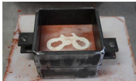
Abb. III: Abguss eines Multi-Tool aus Al
