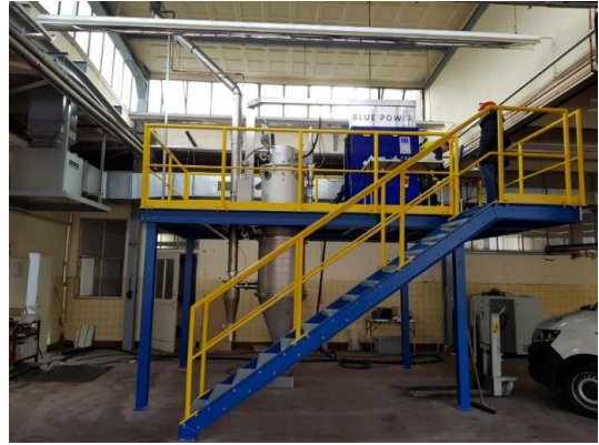
Gasverdüsungsanlage AU3000 im Technologiecampus 3D-Materialdesign
