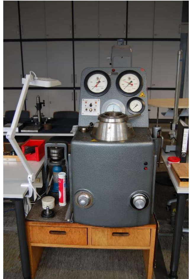
Elektrohydraulische Blechprüfmaschine ROELL & KORTHAUS BP612N
