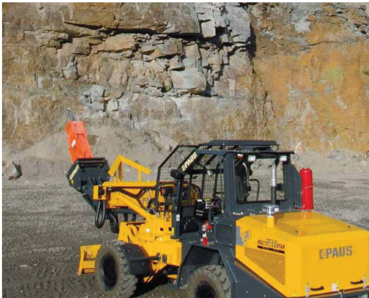
Abb.: Unter-Tage-Streckensicherungsfahrzeug Scaler der Firma Paus
