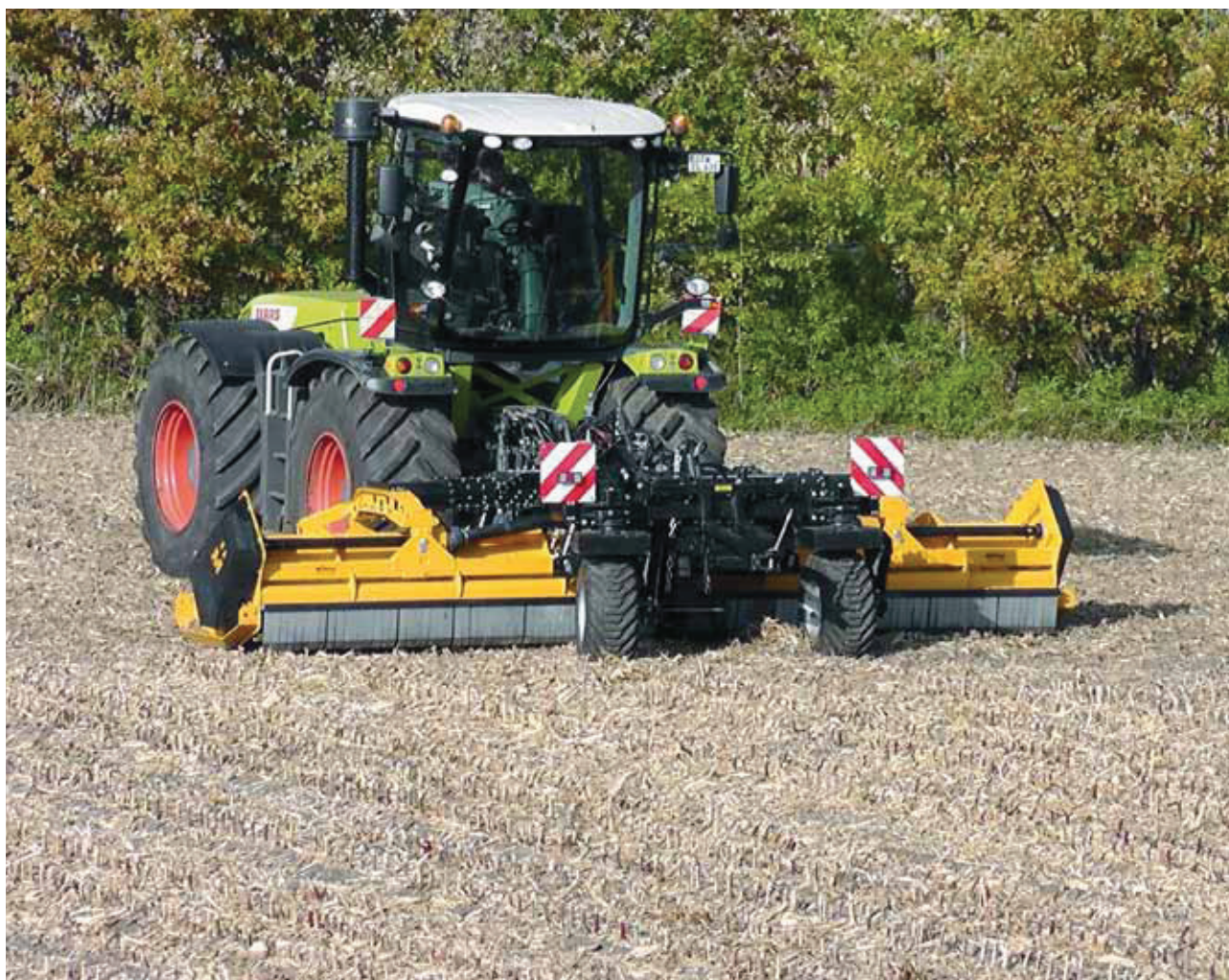
Abb. 1: Großflächenmulcher für den landwirtschaftlichen Einsatz (Werkbild Fa. Müthing)
