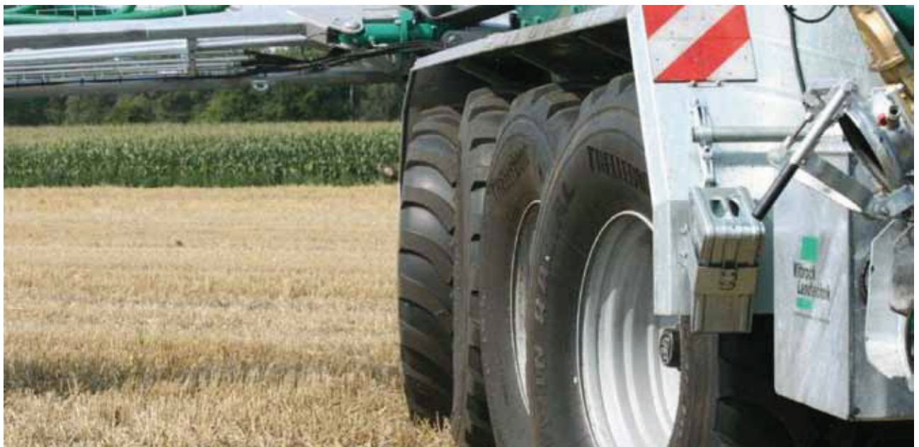
Abb.: Alle Achsen gelenkt; der Starrdeichselanhänger folgt der Schlepperspur
