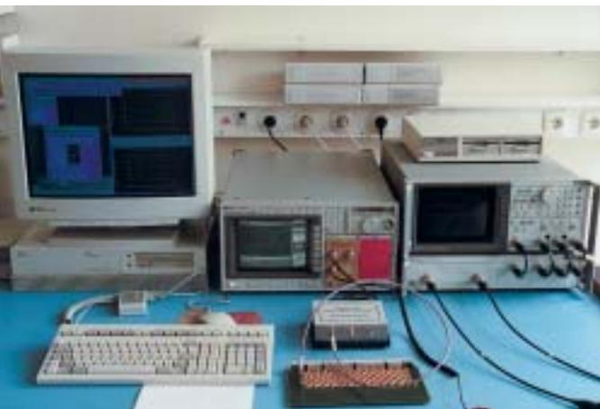
Meßplatz des Projekts mit Workstation (IC-CAP, SPICE), Vektoriellen Netzwerkanalysator HP 8753C, Digital-Oszilloskop HP54750A und Testaufbau
