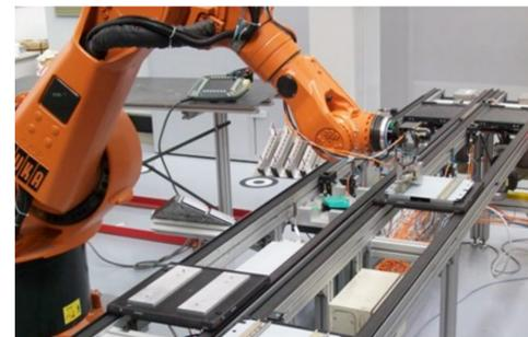
Linetracking: Aufsetzen von Hutschienen
