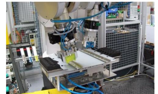
Mehrrobotermontage: Montage von Elektroklemmen
