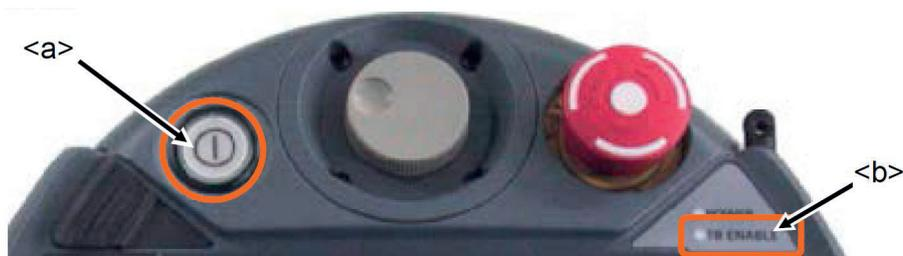
Führen Sie die folgenden Operationen aus, um das Programm zu durchlaufen und den Roboter zu bewegen. Während der gesamten Zeit muss der Freigabeschalter am Handbediengerät leicht gedrückt werden und die Motoren des Roboters müssen eingeschaltet sein.
