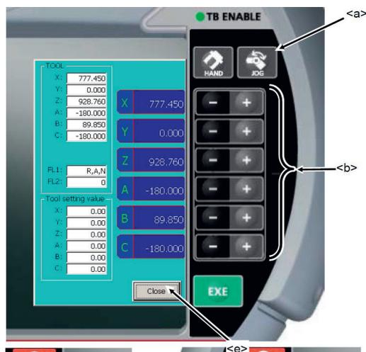
Drücken Sie die Tasten (+ oder -) der gewünschten Bewegungsrichtung. Die Roboterachsen bewegen sich dadurch koordiniert und das Werkzeug (soweit ein Werkzeug am Flansch befestigt wurde) bewegt sich in die jeweilige Richtung, solange wie die Taste gedrückt wird.
