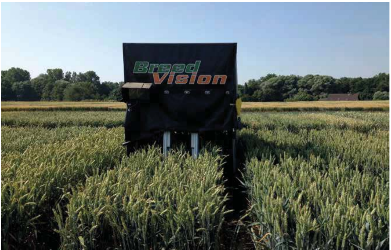
Abb.: Erste Feldmessungen (in Moosburg bei München) im Projekt predbreed mit der Sensorplattform BreedVision.
