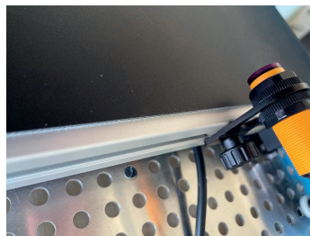
Abbildung 39: Befestigung der Lichtschranke an der Gewindeplatte des Förderbandes
