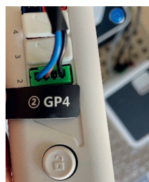
Abbildung 40: Anschluss Lichtschranke DOBOT
