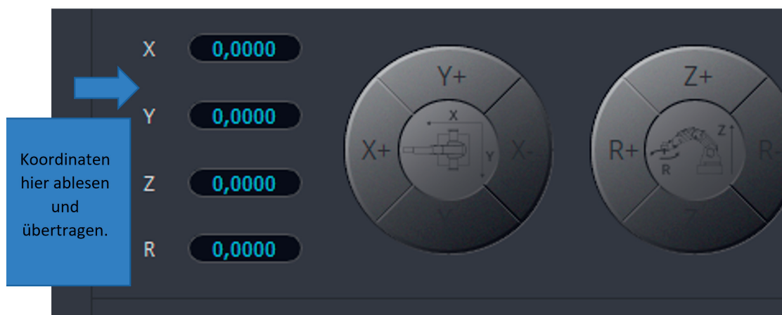
Abbildung 9: Ablesen der Koordinaten am Steuerkreuz
