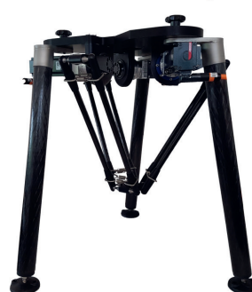
Parallelkinematik: Labor-Prüfstand am Institut für Mechatronische Systeme
