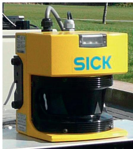
Abbildung 7: Ein Lidar in einem mobilen Roboter von der Firma SICK<sup>1</sup>
