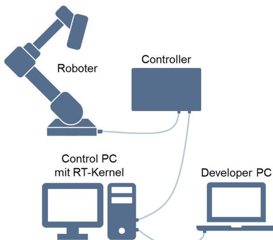
Beim zweiten Setup wird ein Control PC mit installiertem Real-Time Kernel direkt mit dem Mastercontroller des Franka Roboters verbunden (via Ethernet). Der Programmcode und das Starten von Programmen erfolgt jedoch auf einem (oder mehreren) Developer PCs, welche wiederum mit dem Control PC verbunden sind (via Ethernet).
