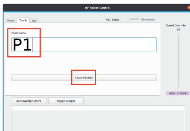
Nachdem der **User Stop** des Roboters gelöst wurde, kann der Roboter bei gleichzeitiger Betätigung des **Guiding Tasters** und **Zustimmungsschalters** manuell bewegt werden, um eine neuen Punkt zu „teachen“.
