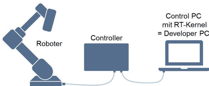
Bei diesem Setup wird nur ein einzelner PC benötigt, welcher gleichzeitig zur Programmierung (= Developer PC) und Ansteuerung (= Control PC) des Franka Roboters genutzt wird. Der PC, welcher einen installierten Real-Time Kernel benötigt, ist direkt mit dem Mastercontroller des Franka Roboters verbunden.
