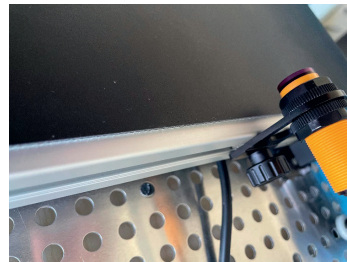
Abbildung 39: Befestigung der Lichtschanke an der Gewindeplatte des Förderbandes
