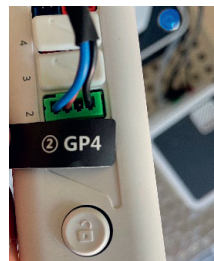
Abbildung 40: Anschluss Lichtschanke DOBOT
