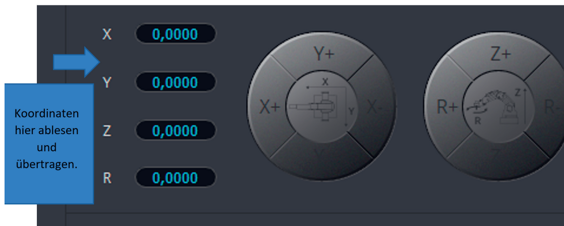
Abbildung 9: Ablesen der Koordinaten am Steuerkreuz
